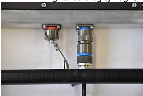
Rysunek 4-5: Połączenie osiowe pierwszej wagi SAW
